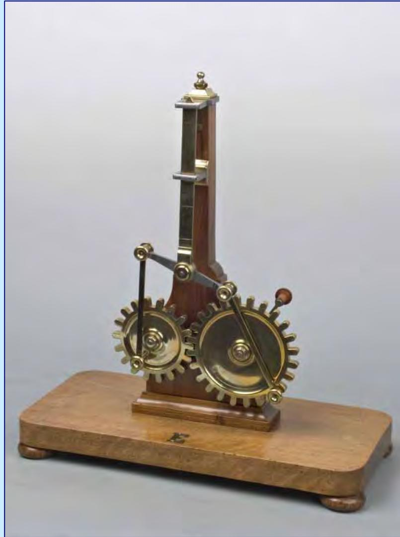
**Modello relativo alla trasformazione del moto circolare continuo in moto rettilineo alternato
